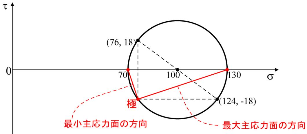
すなわち、問題の応力状態は、主応力を用いて下図のように示される。
