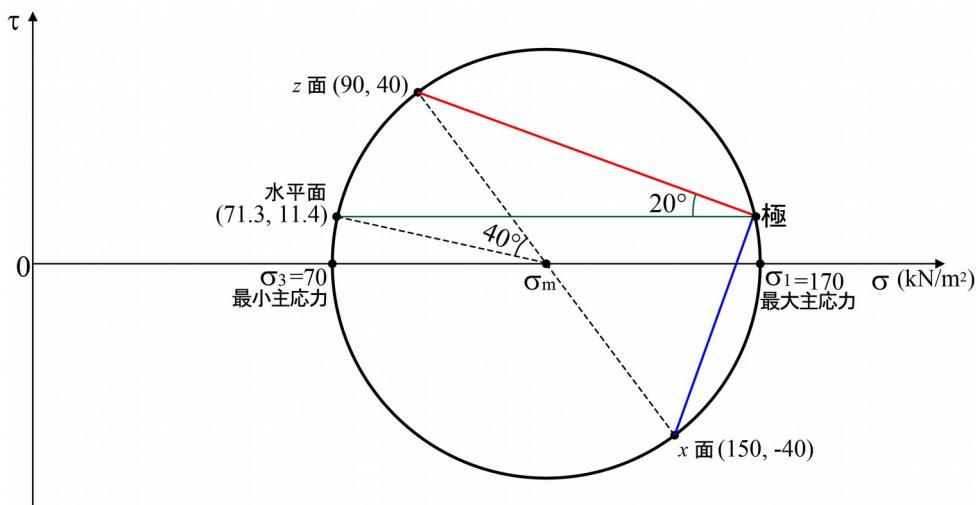
※せん断応力の符号が逆の解答が多く見られた。「反時計回りの応力が正」を忘れないこと
